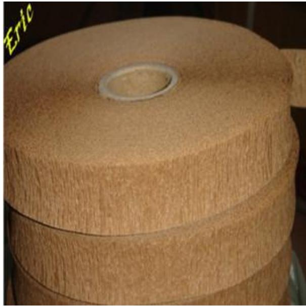
绝缘皱纹纸运用的地方绝缘皱纹纸，主要应用于变压器包扎引线上：1、因为绝缘皱纹纸可以和变压器油形成油-纸绝缘组合。这两者的介电常数比较接近。可以使其间的电场更均匀。2、引线弯折，绝缘皱纹纸可以随引线而弯折，不会折断，能够满足机器的要求。3、能够起到绝缘的作用，包上绝缘皱纹纸后，绝缘电压会提高。鲁腾绝缘专业生产的绝缘皱纹纸，这些都是经过专业处理之后形成的，都是经过\*\*认可的，质量相对过关，大家可以放心使用。
